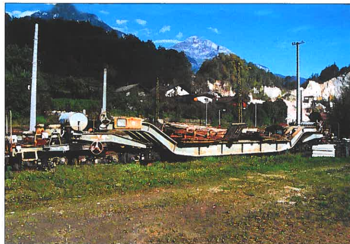
Zillertalbahn (ZB): Der zwölfachsige Tiefladewagen wurde seinerzeit zum Transport großer Teile für den Bau eines Wasserkraftwerkes beschafft. Das Bild vom Tieflader entstand im November 1998 in Mayrhofen. Foto: Siegfried Strzysch
