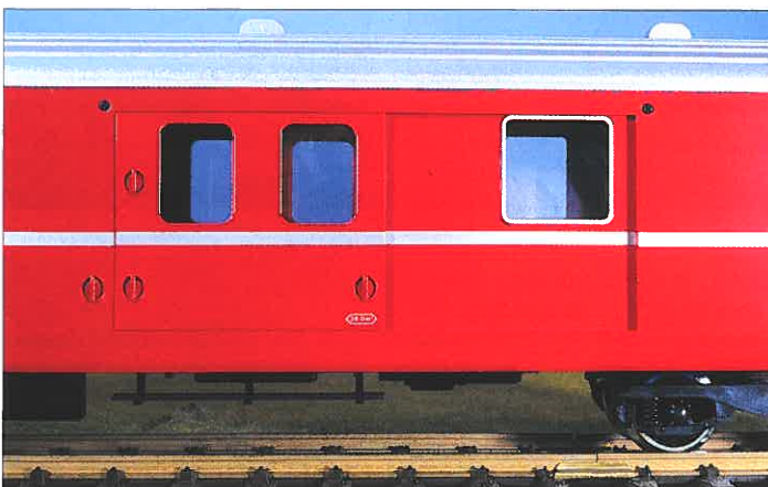
LGB 32690: Die in die Seitenwand eingelassene Gepäckraumtür.
