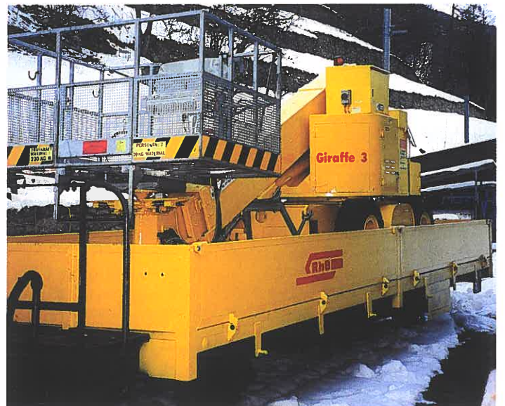
RhB: Xk 9371 mit Hubbühnenstraßenfahrzeug für den Fahrleitungsbau.
